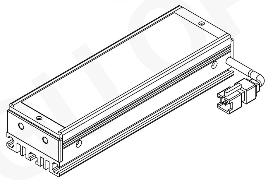
JST 3PIN连接器最小弯曲半径: 20mm
