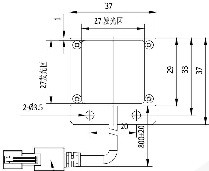
JST 3PIN连接器最小弯曲半径: 20mm
