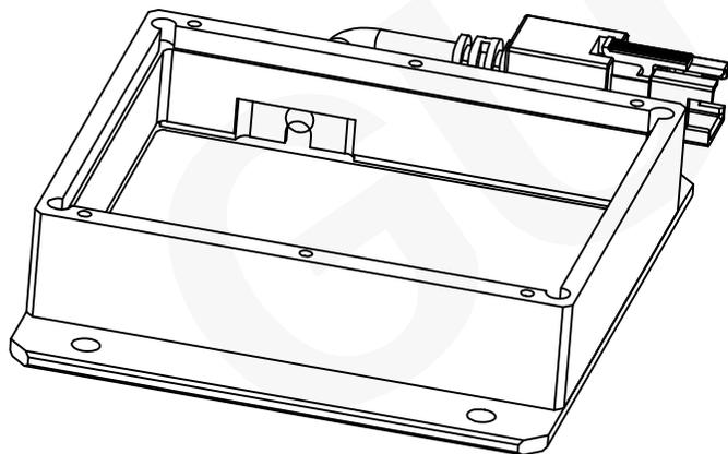
JST 3PIN连接器最小弯曲半径: 20mm
